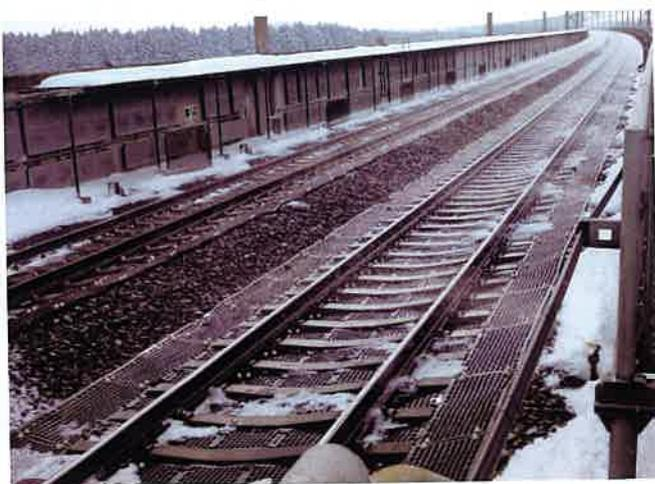
図16 渦室発振素子で融雪され雪がなくなった新幹線線路
