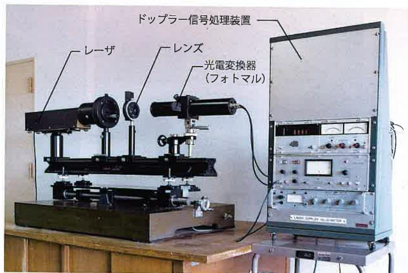
図4 レーザドップラー流速計
