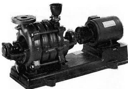
図3.14 エハラ 100MSIVM型ダブル・ボリュートポンプ（図は100 MSⅢM型を示す）（送水量1 m<sup>3</sup>/min, 全揚程70m, 回転数1450rpm, 動力19kW）
