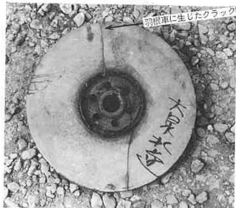
図3.18 S型渦巻ポンプ羽根車の破損(吸込側裏側)
