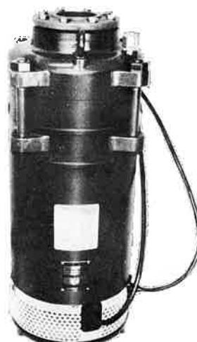
図3.22 エハラ100BMS型水中渦巻ポンプ(送水量1m<sup>3</sup>/min, 全揚程15.5m, 回転数2900rpm, 動力3.7kW)
